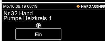
Nr. 32 Funktionsprüfung bzw. manueller Betrieb der Heizkreispumpe 1
