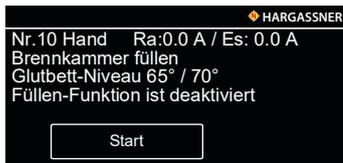
Nr. 10 Vorbefüllen der leeren Schnecken (speziell bei Neustart)
