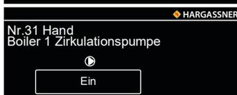
Nr. 31 Funktionsprüfung bzw. manueller Betrieb der Zirkulationspumpe Boiler 1
