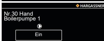
Nr. 30 Funktionsprüfung bzw. manueller Betrieb der Boilerladepumpe 1
