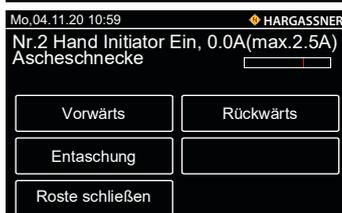
Nr. 2 Funktions- und Drehrichtungsprüfung des Ascheaustragungsmotors
