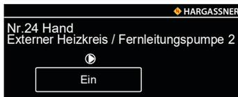
Nr. 24 Funktionsprüfung bzw. manueller Betrieb der externen Heizkreis- oder Fernleitungspumpe 2
