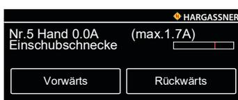
Nr. 5 Funktions- und Drehrichtungsprüfung des Einschubschneckenmotors
