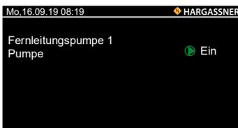
Verfügt ein Heizkreis über eine Fernleitung, wird der Status der Fernleitungspumpe auf dieser Seite angezeigt (grün = **Ein**, weiß = **Aus**).
