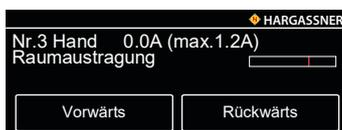
Nr. 3 Funktions- und Drehrichtungsprüfung des Raumaustragungsmotors
