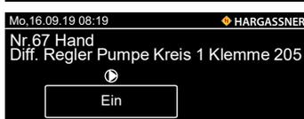
Nr. 67, 67a Funktionsprüfung bzw. manueller Betrieb der Pumpen der Differenzregelung
