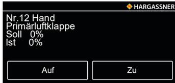
Nr. 12 Funktions- und Positionsprüfung der Primärluftklappe (SOLL / IST)
