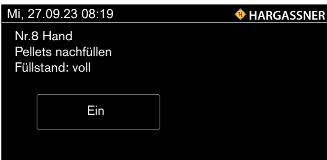
Nr. 8 Auffüllen des Tagesbehälters
