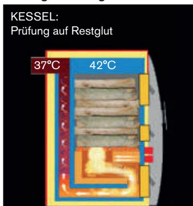
Liegt keine Wärmeanforderung an und ist der Kessel im Zustand **Zündung warten**, erfolgt nach 30 Minuten einmal die Prüfung auf Restglut. Die Werkseinstellung für die Dauer der Prüfung auf Restglut ist 120 Sekunden.
