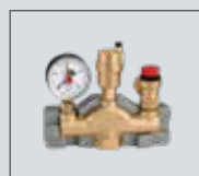
Massiver Messingguss, Anschluss 1" IG Sicherheitsventil 1/2" x 3/4" bis 50kW
