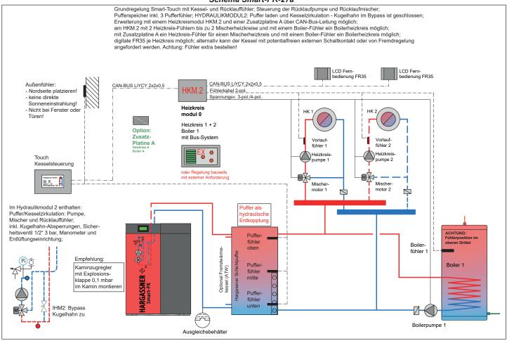
ACHTUNG: Sicherheitsventil, Entlüftung, Manometer, Thermometer, Ausdehnungsgefäß, Absperrungen, etc. sowie Sicherheitsthermostat an Kunststoffleitungen sind nicht dargestellt. Elektroverdrahtung vereinfacht dargestellt - siehe Installationsanweisung! Es kann kein Anspruch auf Vollständigkeit erhoben werden!
