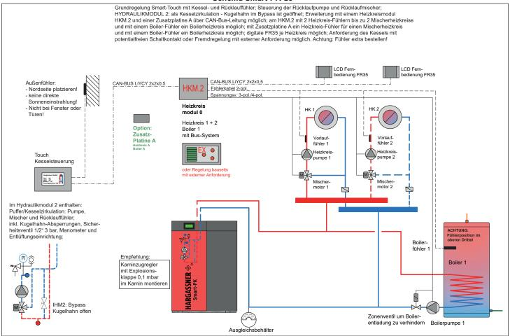
ACHTUNG: Sicherheitsventil, Entlüftung, Manometer, Thermometer, Ausdehnungsgefäß, Absperrungen, etc. sowie Sicherheitsthermostat an Kunststoffleitungen sind nicht dargestellt. Elektroverdrahtung vereinfacht dargestellt siehe Installationsamweisung! Es kann kein Anspruch auf Vollständigkeit erhoben werden!
