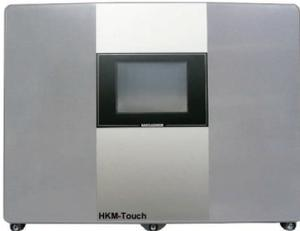
Zur Erweiterung der Heiz- und Boilerkreise können bis zu drei Heizkreismodule angeschlossen werden. Der Anschluss erfolgt mit einem Buskabel an der Kesselplatine (am CAN-Stecker).
