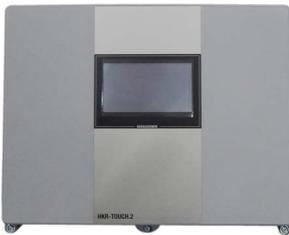
Zur Erweiterung der Heiz- und Boilerkreise sowie von Pufferspeichern und Fremdwärmekeßeln können bis zu 16 Heizkreisregler angeschlossen werden. Der Anschluss erfolgt mit einem Buskabel an der Kesselplatine (am CAN-Stecker).
