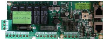
Die Heizkreisplatine dient zur Erweiterung der Boiler- und Heizkreise am Kessel. Der Anschluss erfolgt mit einem Buskabel an der Kesselplatine.
