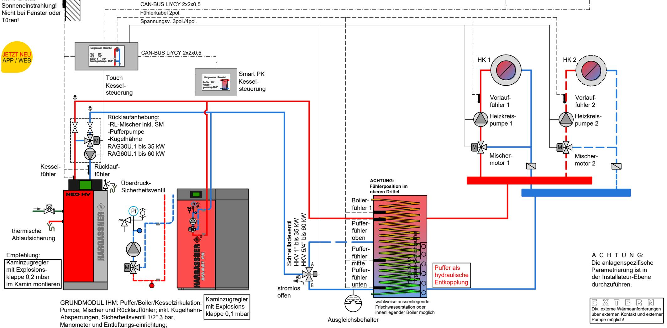
ACHTUNG: Sicherheitsventil, Entlüftung, Manometer, Thermometer, Ausdehnungsgefäß, Absperungen, etc. sowie Sicherheitsthermostat an Kunststoffleitungen sind nicht dargestellt. Elektroverdrahtung vereinfacht dargestellt - siehe Installationsanweisung! Es kann kein Anspruch auf Vollständigkeit erhoben werden!
